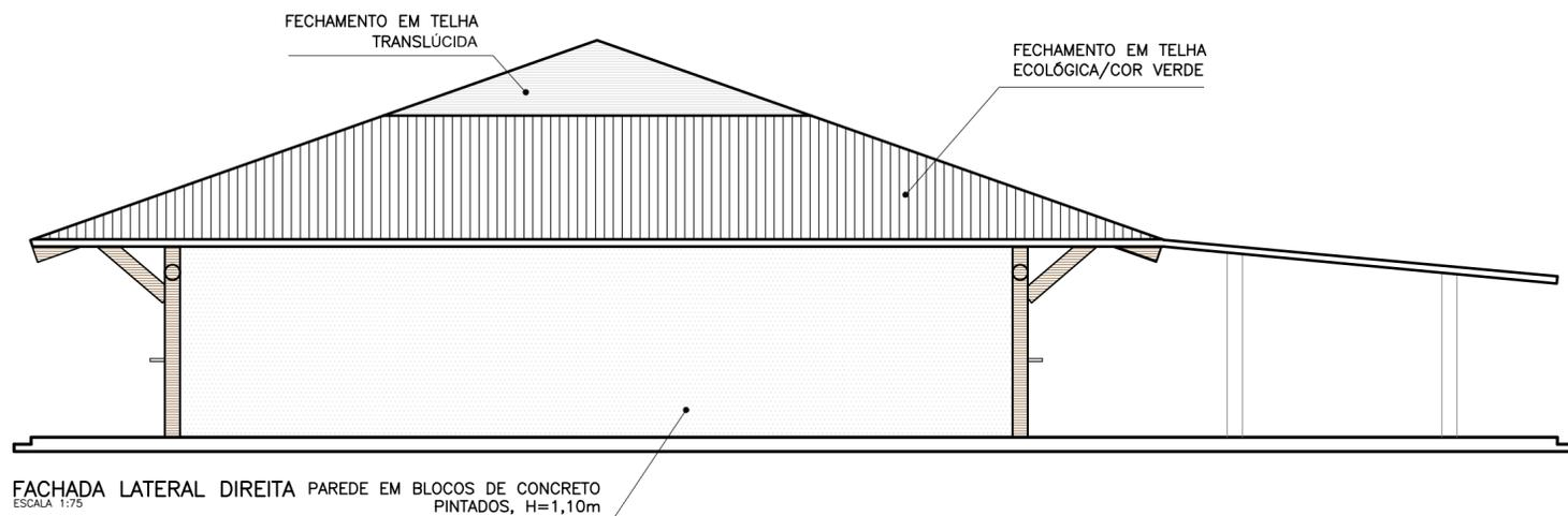
FACHADA LATERAL DIREITA PAREDE EM BLOCOS DE CONCRETO PINTADOS, H=1,10m
